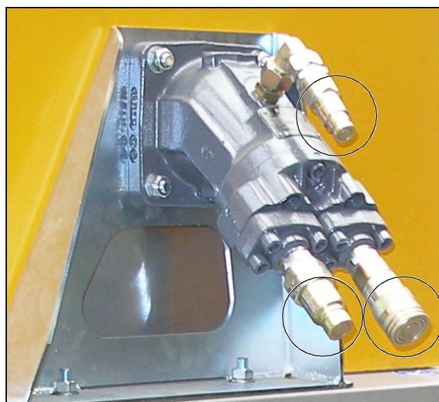
Bild 5.32 Anschlüsse am hydraulischen Seil-Treibradmotor, CSA•1001 H
