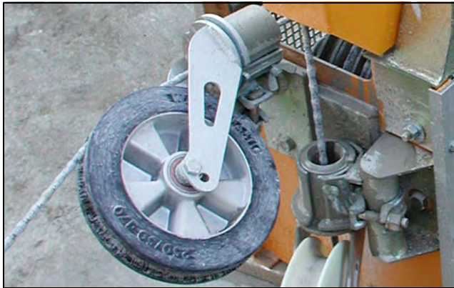
Bild 5.7 CSA-1001, obere (Transport-) Schwenkrolle ausgerichtet
