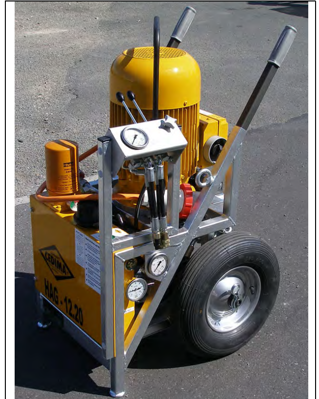
Bild 5.36 Optionales Hydraulikaggregat HAG-12.20, zum Betreiben des CSA-1001 H mit aufgebautem Steuerpult
