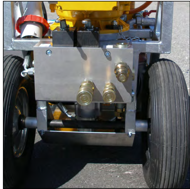
Bild 5.40 Optionales Hydraulikaggregat HAG-12.20, Anschlüsse zum hydraulischen Seil-Treibradmotor, CSA-1001 H
