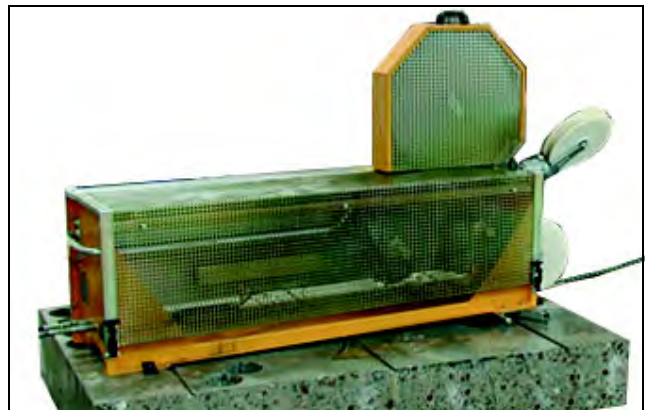
Bild 5.3 CSA-1000 Seilsägeautomat angedübelt
