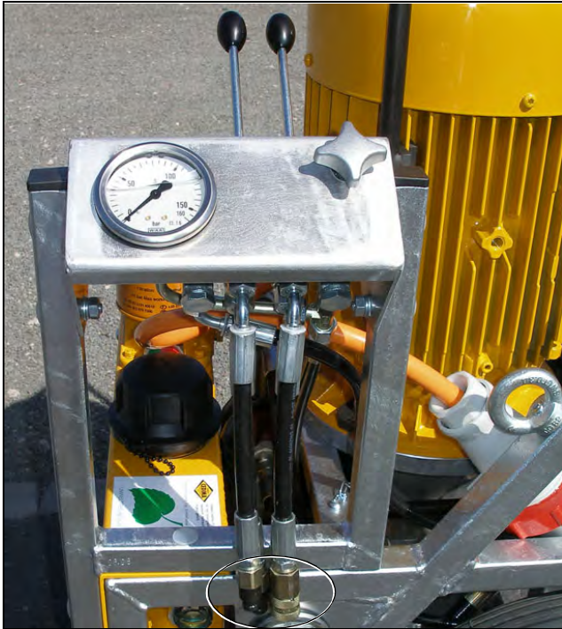
Bild 5.38 Kupplungen (der 2 möglichen Steuerblöcke) für den hydraulischen CSA-1001 H Vorschub am (unter dem) Steuerpult des optionalen Hydraulikaggregat HAG-12.20
