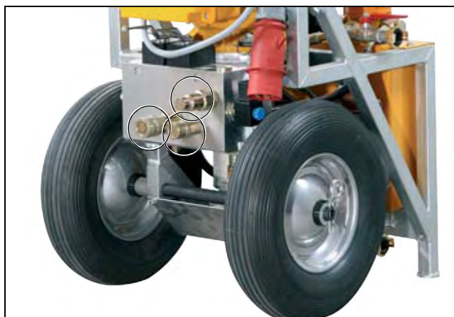
Bild 5.31 HAG•324, Anschlüsse zum hydraulischen Seil-Treibradmotor, CSA•1001 H
