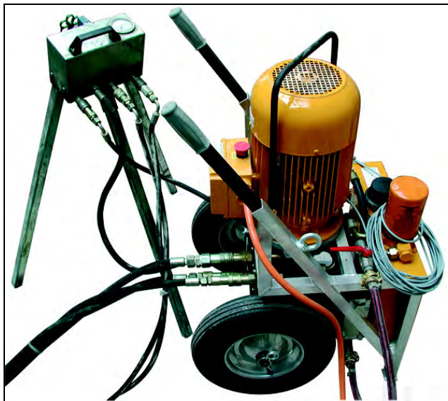
Bild 5.21 Hydrauliksteuerpult HSP-12 und hydraulischer Seiltreibradmotor (Schlauchpaket) am HAG-12.10 angeschlossen
