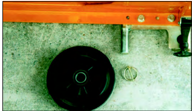
Bild 5.2 CSA-1000, linkes Transportrad demontiert
