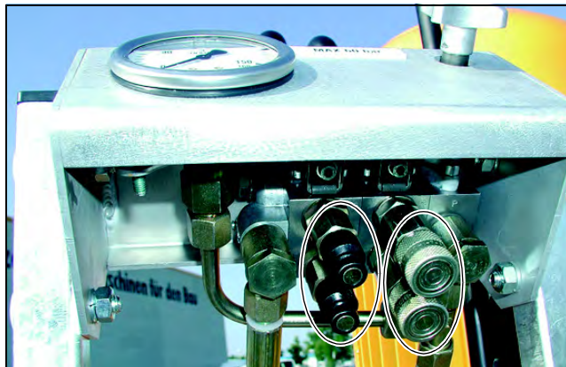
Bild 5.29 Kupplungen (der 2 möglichen Steuerblöcke) für den hydraulischen CSA•1001 H Vorschub am (unter dem) optionalen Steuerpult des optionalen Hydraulikaggregat HAG•324
